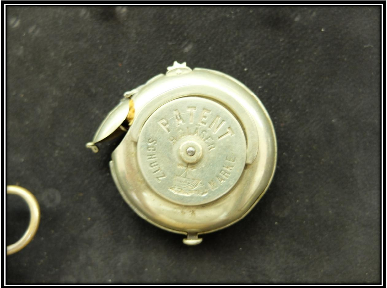
Abbildung 5 – Sandstein-Korundfeuerzeug zum aufziehen.
